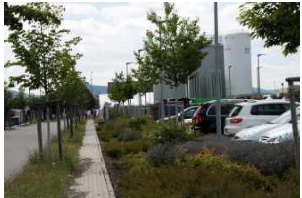
Abbildung 106 - Gutes Beispiel im Gewerbepark „Am Messiegelände“ in Landau: Baumpflanzungen, beschatteter Fußweg und Versickerung von Oberflächenwasser im Pflanzbeet (Bild: faktorgruen).
