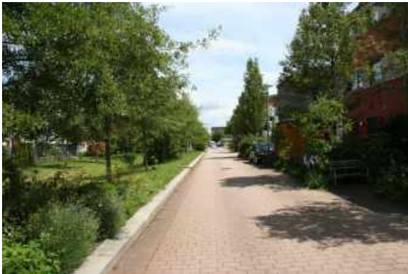
Abbildung 138 - Die Straßenräume im Quartier Vauban in Landau haben Vorbildcharakter: Angepasste Straßenquerschnitte, großzügige Baumpflanzungen, und Baumquartiere, nachhaltiges Regenwassermanagement (Bild: faktorgruen).
