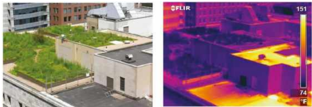
Abbildung 27 - Differenz der Oberflächentemperatur mit und ohne Begrünung auf der Dachfläche des National Center of Excellence, Arizona State University (Bilder: U.S. Environmental Protection Agency, 2008 Reducing Urban Heat Islands: Compendium of Strategies)
