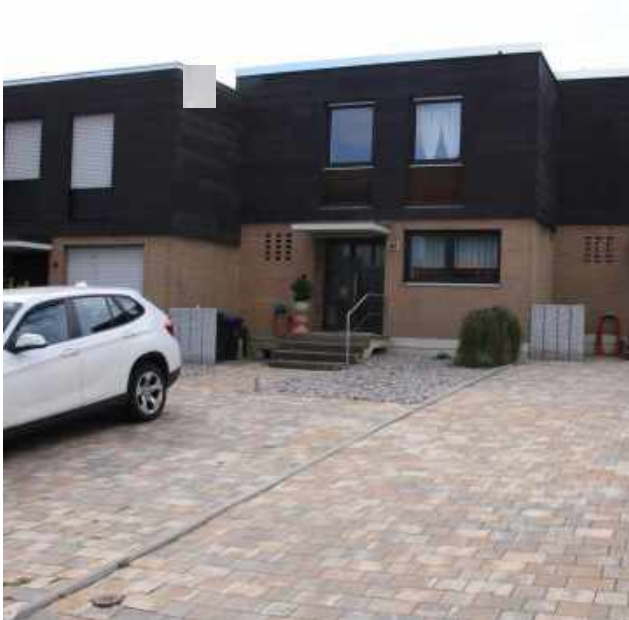
Abbildung 38 – Befestigte Flächen und Schottergärten erhöhen die thermische Belastung des unmittelbaren Wohnumfeldes und besitzen keinen ökologischen Wert (Bild: faktorgruen).
